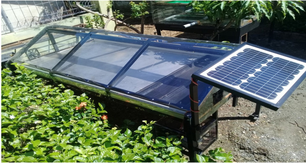
Gambar 2. Pengering terowongan Hohenheim Aceh dimensi panjang 2m dan lebar 1m % (Khathir et al., 2020b)
