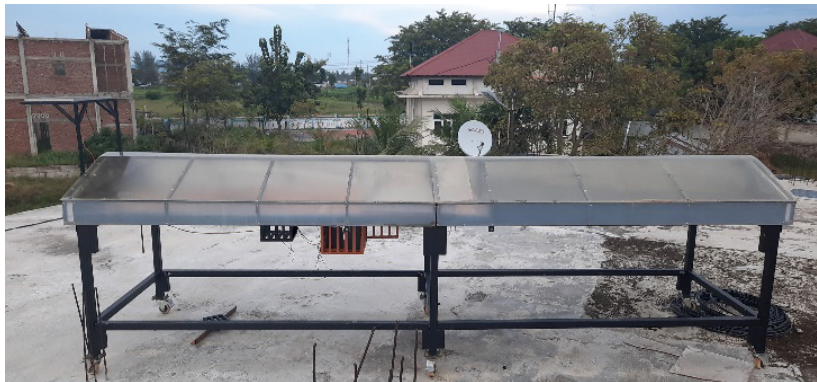
Gambar 4. Alat pengering terowongan Hohenheim Aceh panjang 3m dan lebar 1m (Sumber: Dokumen pribadi)
