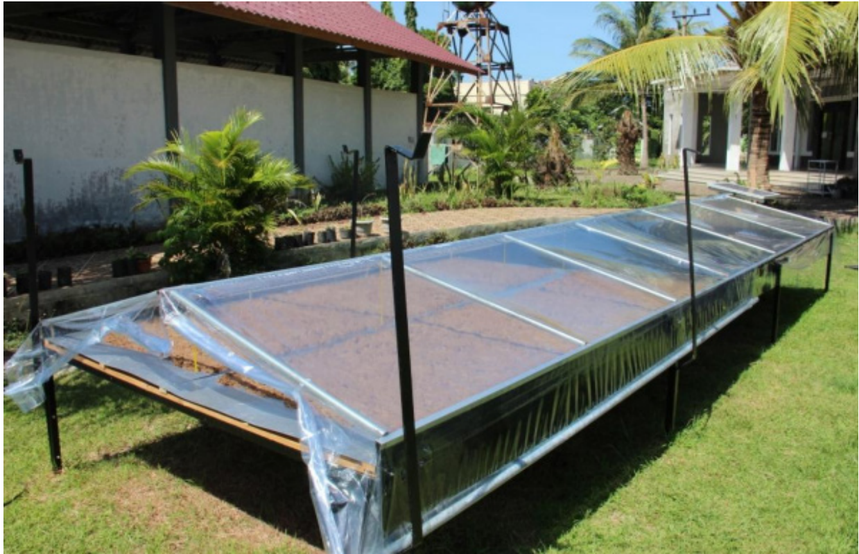
Gambar 1. Pengeringan pliek-u dengan pengering terowongan Hohenheim Aceh dimensi panjang 6m dan lebar 2m (Khathir et al., 2015).
