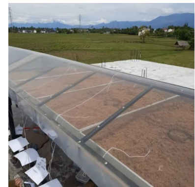
Gambar 4. Alat pengering terowongan Hohenheim Aceh panjang 3m dan lebar 1m (Sumber: Dokumen pribadi)
