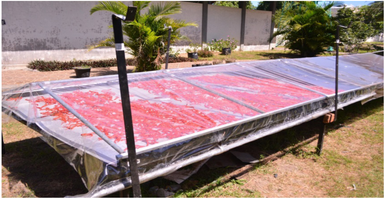
Gambar 3. Pengerian cabai dengan pengering terowongan Hohenheim Aceh dimensi panjang 6m dan lebar 2m (Ridwan et al., 2017)
