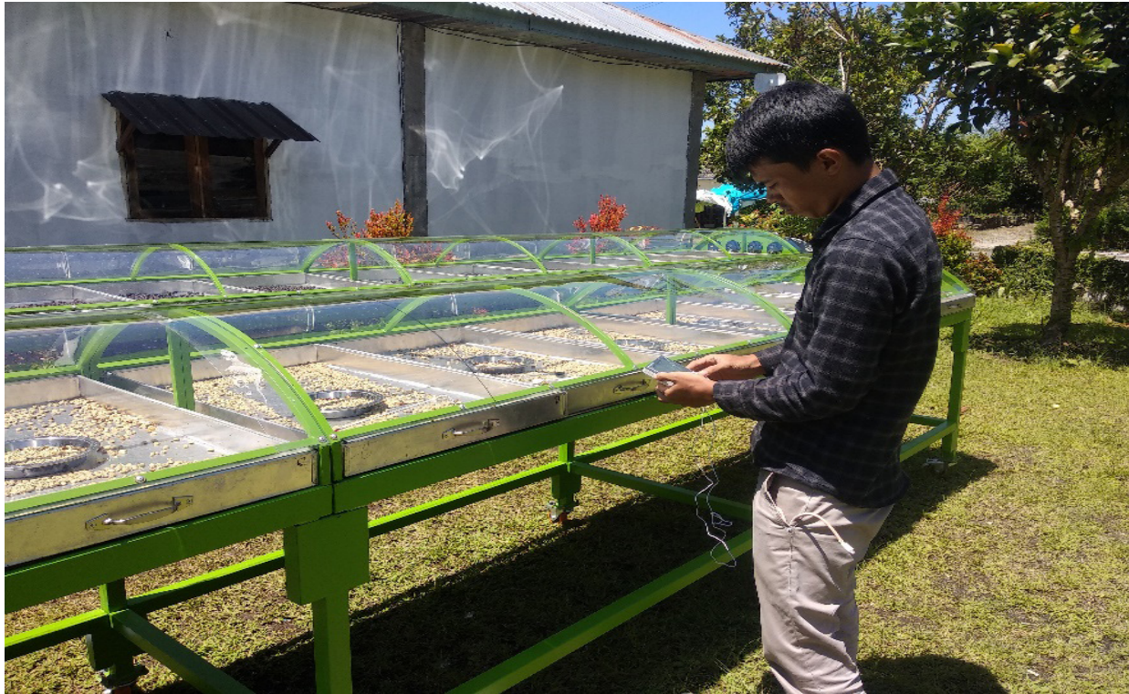
Gambar 6. Pengeringan kopi dengan pengering terowongan Hohenheim Aceh dimensi panjang 6m dan lebar 1m (Hardi et al., 2019).
