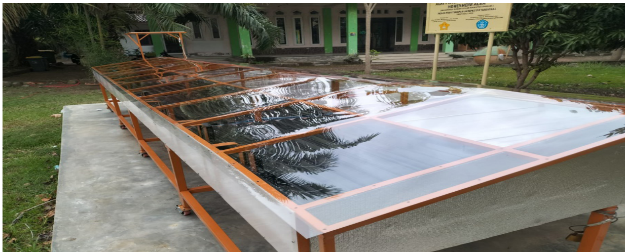
Gambar 8. Pengering terowongan Hohenheim Aceh dengan solar kolektor paralel ukuran panjang 6m dan lebar 2m (Sumber: Dokumen pribadi)
